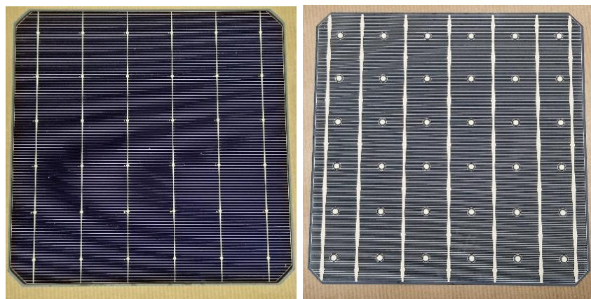
Figuur 5. Een MWT silicium HJT zonnecel, vervaardigd met een proces dat sterk lijkt op het MWT tandemzonnecelproces. Afmeting 156.75mm x 156.75mm. Met dit type zonnecel kon met name Lightyear ontwikkeling voor de zonnepaneeltechnologie verrichten (als 'stand-in' voor de toekomstige tandemzonnecellen). Links voorzijde, rechts achterzijde. De losstaande witte puntjes op de achterzijde zijn de contacteringspunten die verbonden zijn met de voorzijde via de metalen kanaaltjes (via's).
