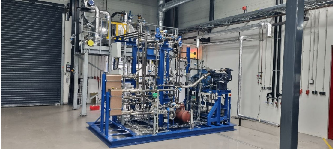
Figuur 3.5 Hoge-temperatuur warmtepomp In het Carnot-laboratorium TNO
