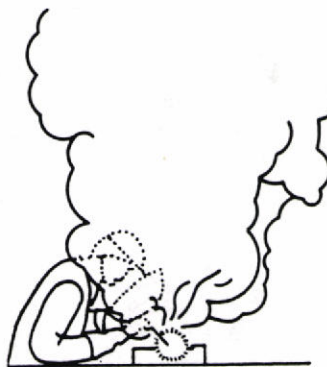
Afb. 1 Directe indringing van de lasrook in de ademzone bepaalt in hoge mate de blootstelling.
