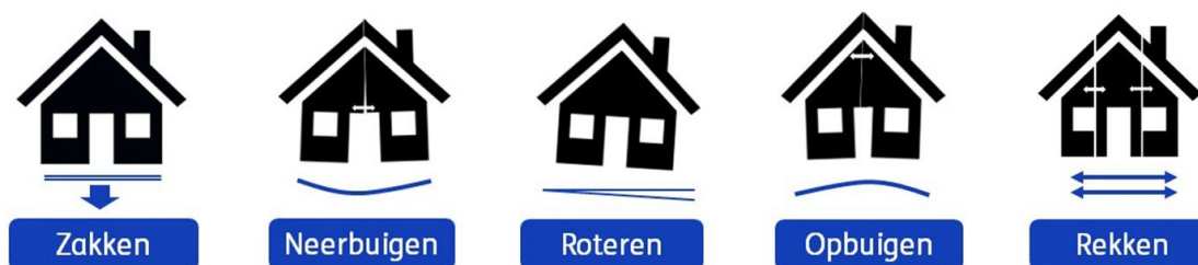
Figuur 2 Schematische weergaven van gebouwvervormingen gerelateerd aan funderingen.
