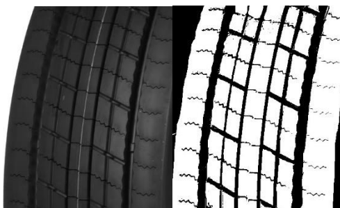
Figuur B.1: Foto van vrachtwagenband en omgezet in zwart wit met behulp van ImageJ.
