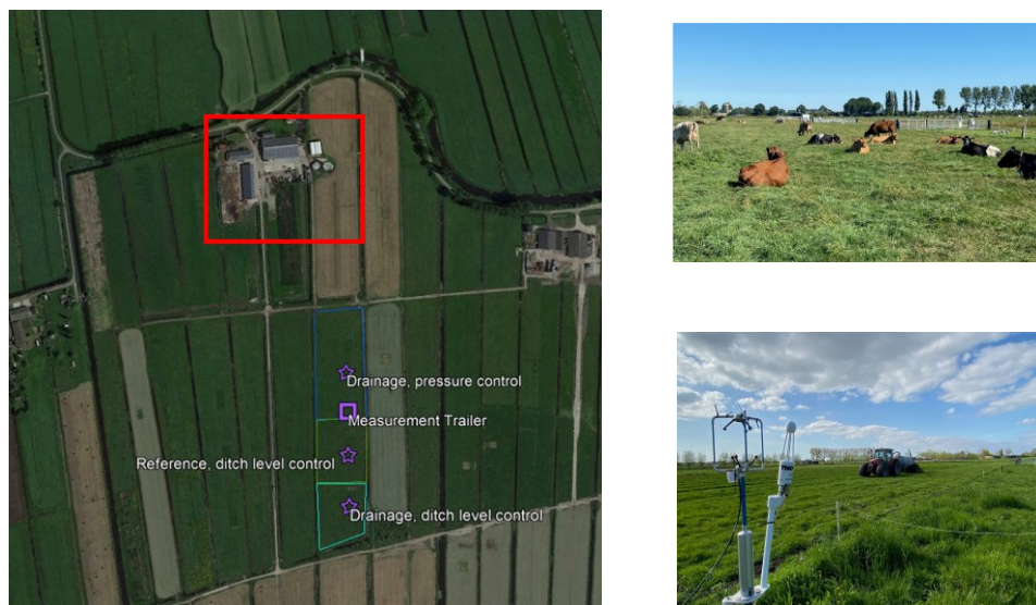
Figuur 2.5: De meetopstelling bij Zegveld om verschillen in emissies van koolwaterstofdioxide en lachgas naar type grondwaterbeheer in kaart te brengen en relevante, contextuele factoren binnen deze studie (onder andere grasland met grazende koeien, het periodiek uitrijden van mest en weersomstandigheden).
