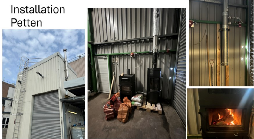
Figuur 3.9: Indruk van de houtkachelopstelling in Petten. Links: De schoorsteen waar de rook door naar buiten gaat. Midden: Twee van de kachels die bemeten gaan worden. Rechtsboven: De schoorsteenpijp in de meetruimte met aansluitpunten voor de meetsensoren. Rechtsonder: Een van de kachels in actie.
