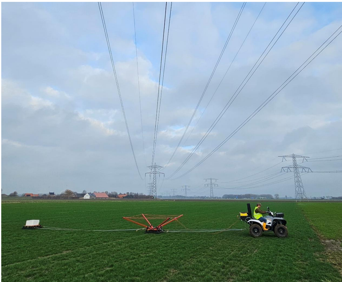
Figuur 2: Opstelling van het tTEM systeem: quad met daarachter het meetapparaat dat het elektromagnetisch signaal uitzendt; het witte instrument meet de response van de bodem. Tennet heeft voorafgaand aan de metingen gedetailleerde kaarten geleverd van de ligging van de leidingen in de leidingstraat. Ook heeft Tennet toestemming geregeld voor betreding van het terrein.
