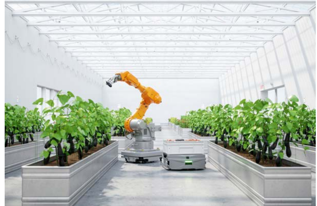
Figuur 2.4 Mobiele plukrobot
