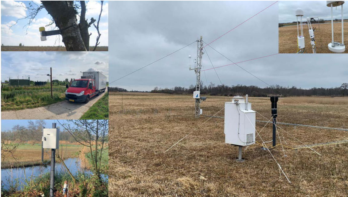
Figuur 15: Diverse meetopstellingen in één figuur: links boven passieve sampler, links midden de meetwagen naast het referentie meetpunt Zegveld, links onder een delta denuder, in het midden de diverse opstellingen op het centrale meetpunt, met rechtsboven een detail,
