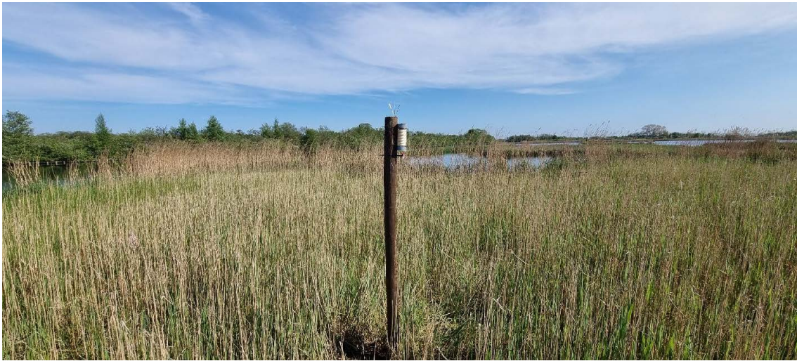
Figuur 18: Voorbeeld van een meetopstelling met passieve samplers bij meetpunt 16 Gat van Achterberg. De \text{NO}_2 buisjes hangen in een koker die de buisjes beschermt o.a. tegen direct zonlicht en om voor een laminaire luchtstroom te zorgen. De \text{NH}_3 buisjes hangen daar net onder.
