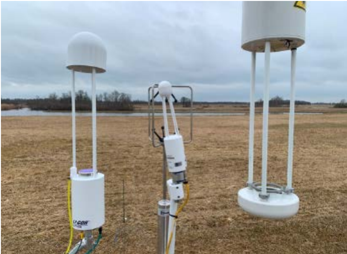
Figuur 16: Foto's van de methaan sensor (LICOR, links), de \text{CO}_2/\text{H}_2\text{O} sensor (LICOR, midden voor), de Sonische anemometer (midden achter) en de ammoniak sensor (Healthy Photon, rechts)
