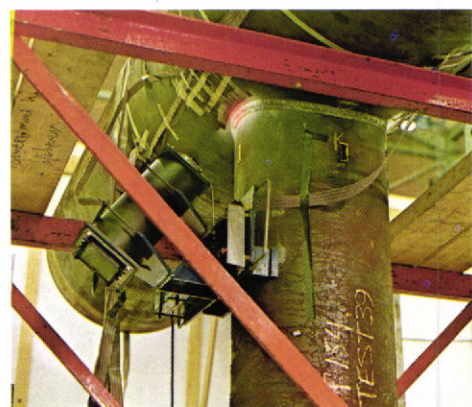
Afb. 7. Samenstel van twee stalen buizen onder wisselbelasting. De camera is in de directe omgeving van de te verwachten scheur aangebracht, waarop ook de (rode) laserbundel is gericht.
