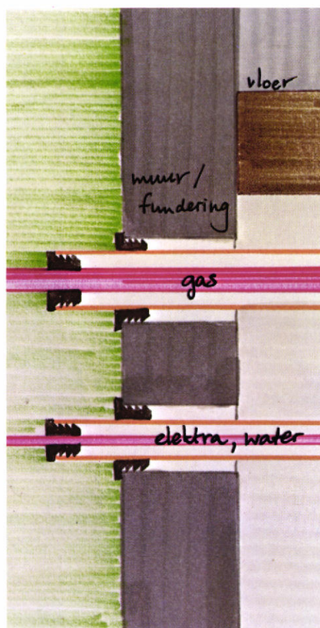
Afb. 1. Afdichting van doorvoerleidingen met de door het KRITNO ontwikkelde pluggen.
