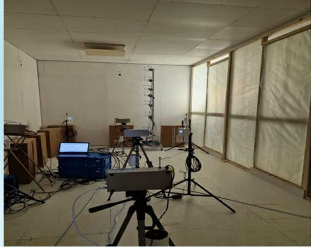
Figuur 7-4. Ventilatieconfiguratie MUS, zwembadkleedkamers met overstort onder (A, B), en overstort bovenzijde (C, D). Er is een plaat onder de toevoer geplaatst (B, D) om de luchtstroom een richting mee te geven.
