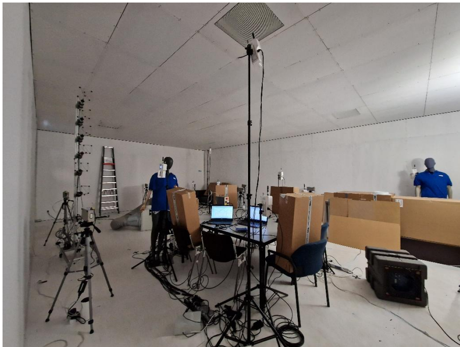
Figuur 2-1. Een meetopstelling in de testfaciliteit inclusief warmtebronnen.
