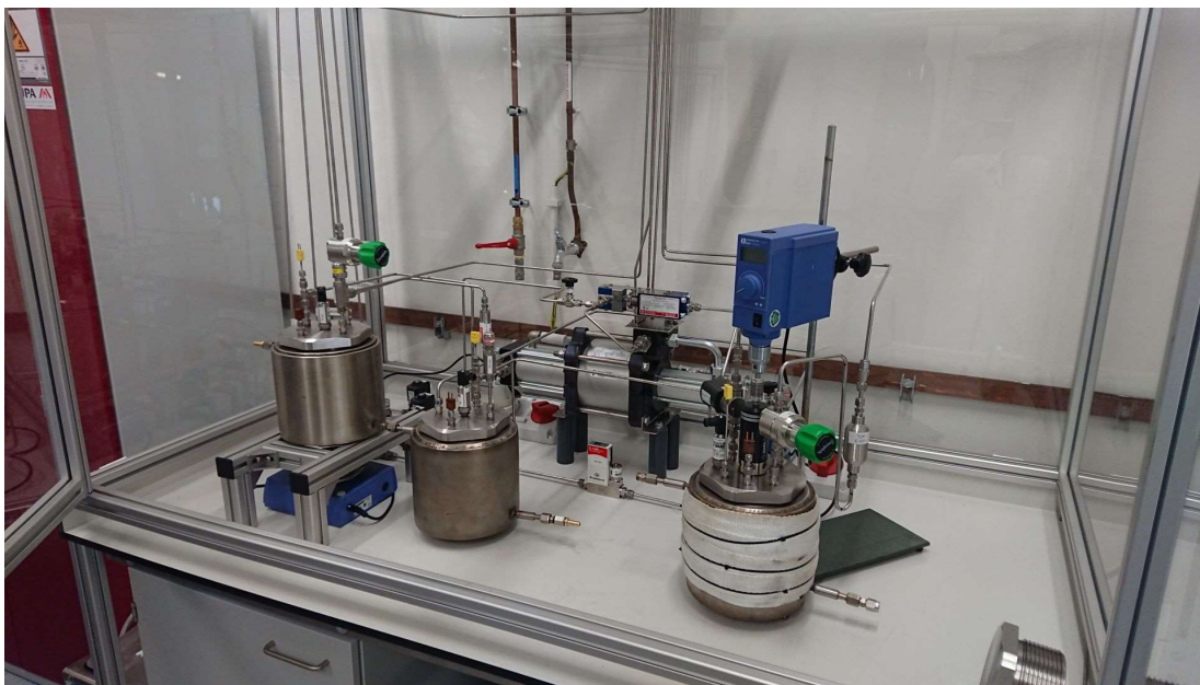
De opstelling waarmee acetyleen wordt gehydrogeneerd naar etheen.
