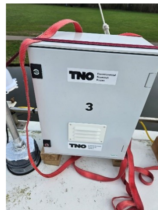
Figuur 2.4 TNO roetsensorkastje ter kalibratie op de meetwagen.
