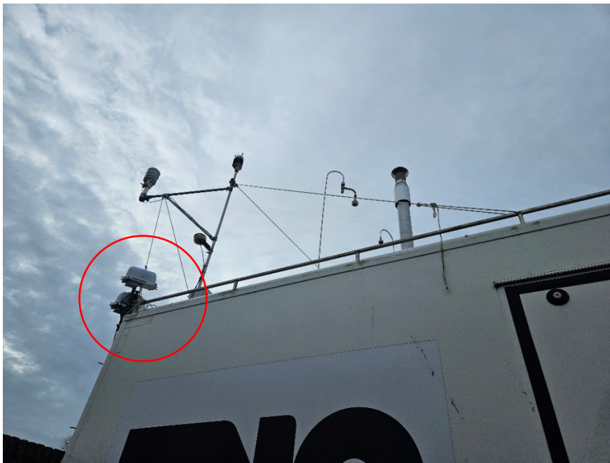
Figuur 2.2: Plaatsing van de SODAQ sensoren op de TNO trailer bij de politie (vanaf 18 januari 2024). Naast de SODAQ sensoren is ook het weerstation te zien, meer naar rechts de 2 inlaten voor de “snelle” meetsystemen in de trailer en (meest rechts) de inlaat voor het filterverzamelinstrument (Leckel).
