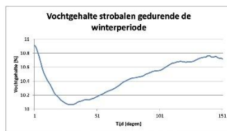
Grafiek 4-18 Vochtgehalte in het stro van een plat strobedek dak gedurende de winter
