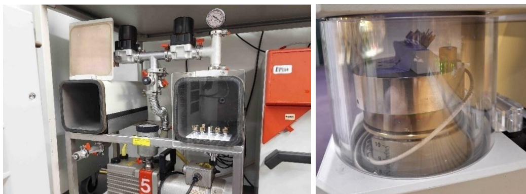
Figuur 3.5 Links: Vacuum-drogen van stro-monsters vóór sputteren. Rechts: Sputteren van dun laagje wolfram op stro-monsters.
