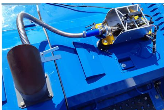
Figuur 3.1: De TNO BOEMkit, geïnstalleerd op een machine met zuignappen.
