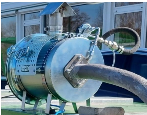
Figuur 4.3: Geplaatst opsteekfilter in bijbehorende behuizing.
