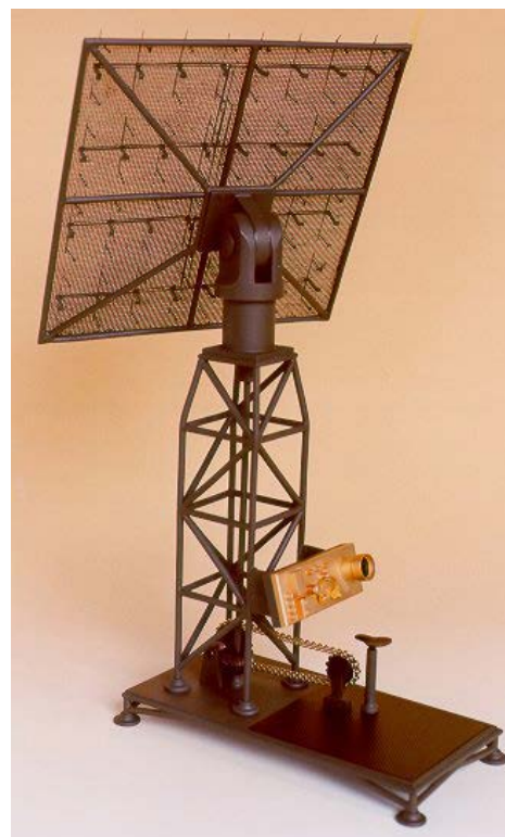
Het elektrische luistertoestel, een voorloper van alle moderne radars
