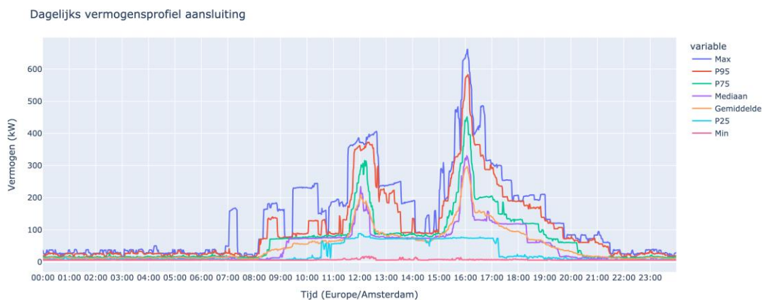
Figuur E.85: Dagprofiel van de netaansluiting van laadplein C
