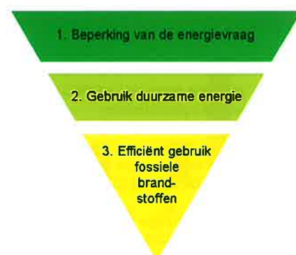
-Figuur 1- Trias energetica, stappen voor energiebesparing
