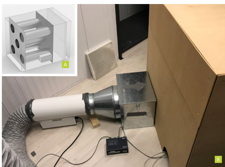
Foto 2a: Elektrostatische filtratie module voor een 10.000 m 3 /h luchtbehandelingskast. In de buizen worden de deeltjes elektrisch opgeladen. Vervolgens wordt dit fijnstof afgevangen door het F7 plaatfilter aan de rechterzijde wat als collector fungeert.
