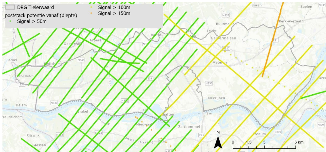
Figuur 3.7: Inschatting van de potentie van seismische lijnen voor herbewerking in de vorm van zgn. post-stack data conditioning.
