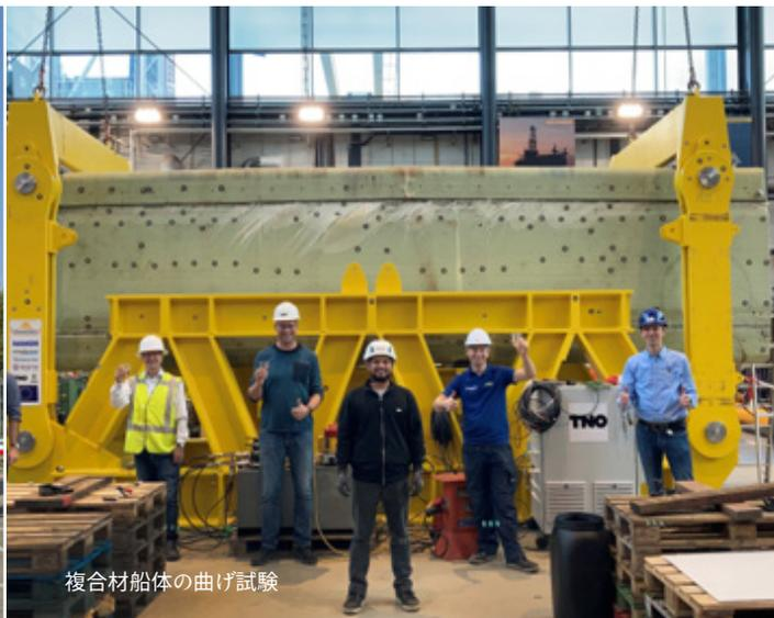
複合材船体の曲げ試験
