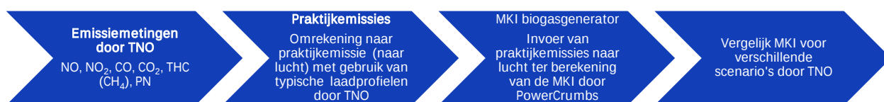
Figuur 1.1: Overzicht van het project met de verschillende stappen van praktijkemissiemeting van de generatorset op biogas naar het vergelijk van de MKI van deze generatorset met alternatieve scenario's.
