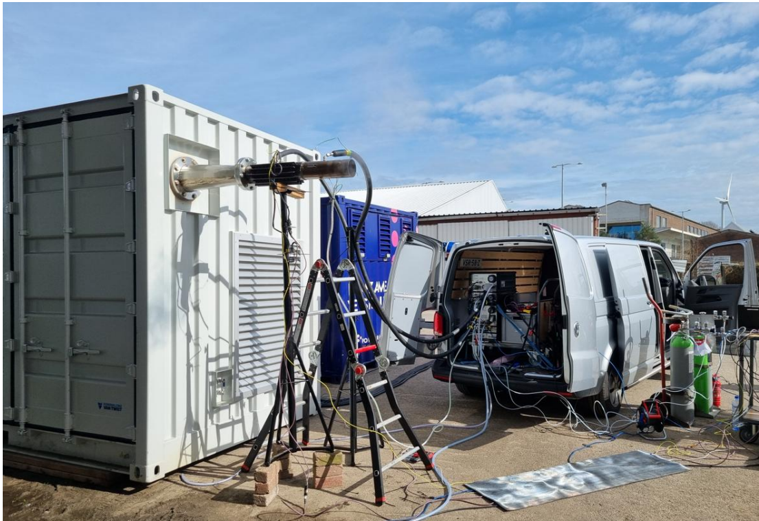
Figuur 2.1: Overzichtsfoto van de meetopstelling. Op de uitlaat van de biogasmotor is een meetbuis gemonteerd met de uitlaatgasdebietmeter van PEMS. Op deze meetbuis zijn aansluitingen en verwarmde leidingen aangebracht voor het bemonsteren en transporteren van het uitlaatgas naar het PEMS-meetinstrument. Deze is opgesteld in de bestelwagen. PEMS meet de concentraties van een reeks schadelijke stoffen in het bemonsterde uitlaatgas. Naast de bestelwagen staan de flessen met ikgassen en brandstof voor de PEMS. Niet op de foto zichtbaar is een zogenaamde 'load bank'. Deze wordt gebruikt om de generator van de biogasgeneratorset elektrisch te belasten. De mate van belasting is instelbaar.
