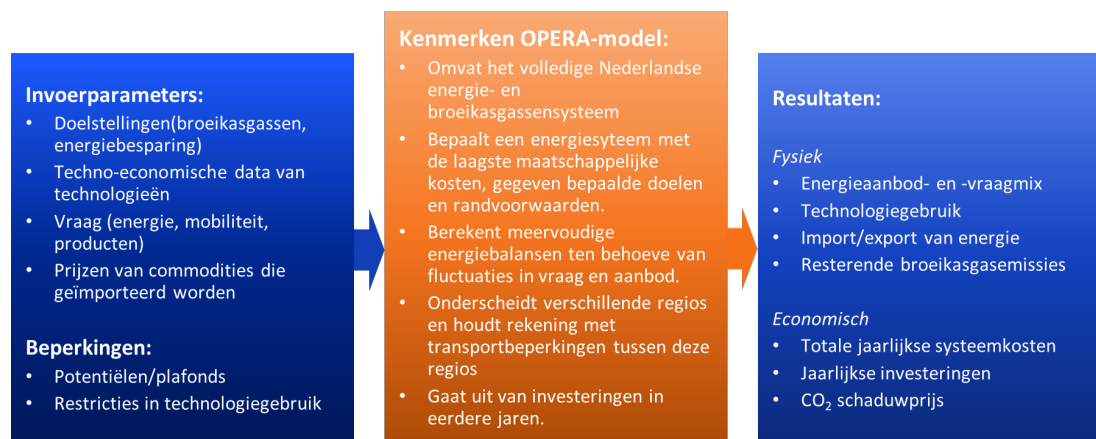
Figuur 2.2: Schematische weergave van het OPERA-model
