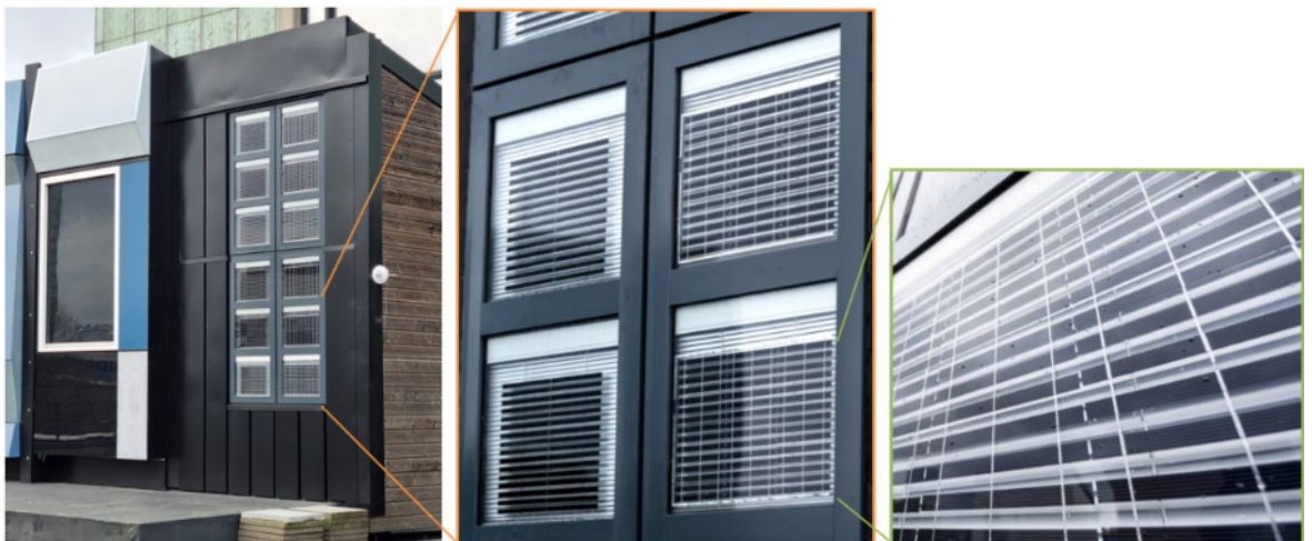
Figuur 17: Foto van de 12 ZIEZO-prototypes op SolarBEAT, met een zoom naar individuele ramen en de cell-strips.
