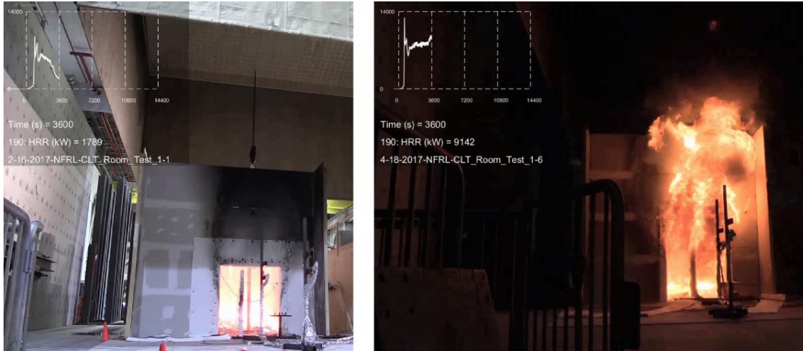
Figuur 5: Volledig beschermd CLT compartiment (links), vergelijkbaar compartiment, met het plafond en een muur blootgesteld (rechts), 1 uur na aansteken.
