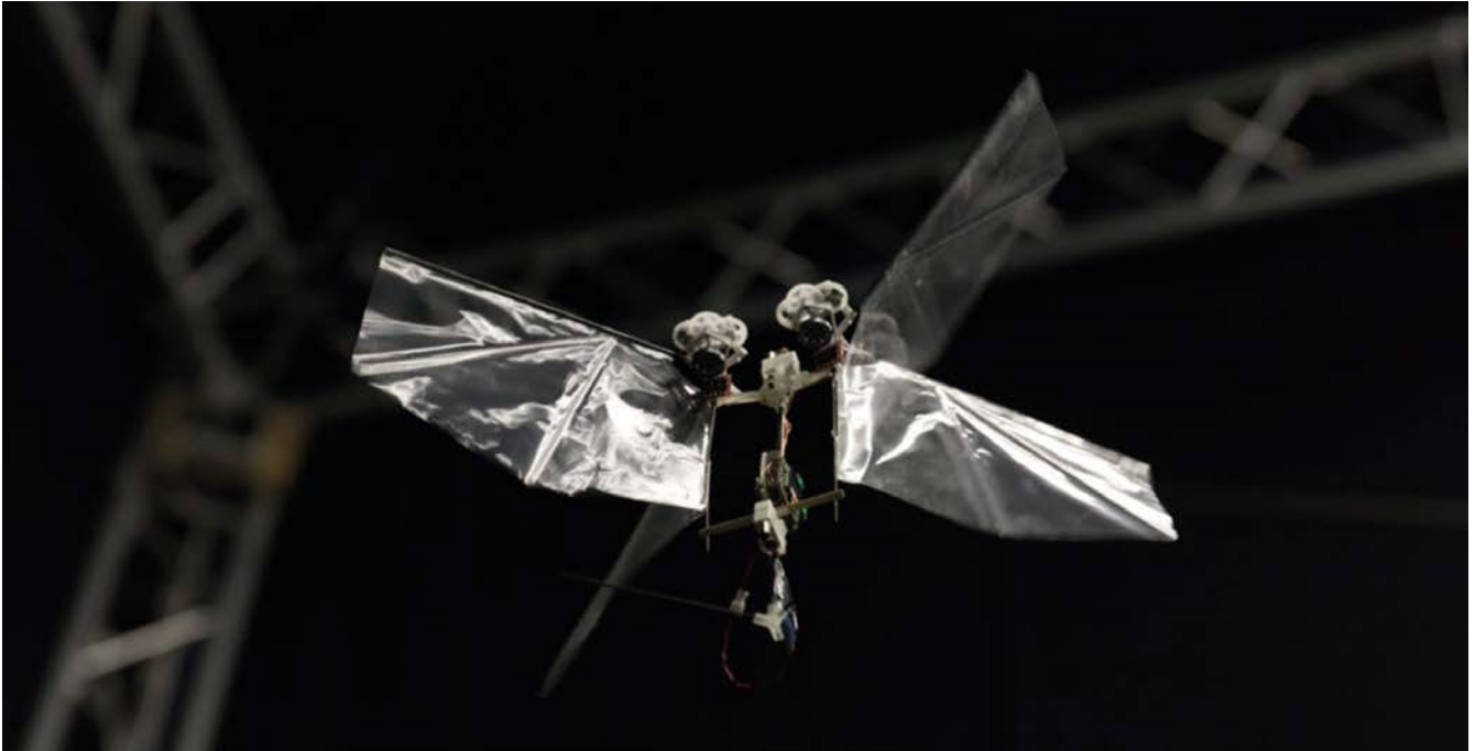
Figuur 5 Delfly – op insecten gebaseerde microdrone
