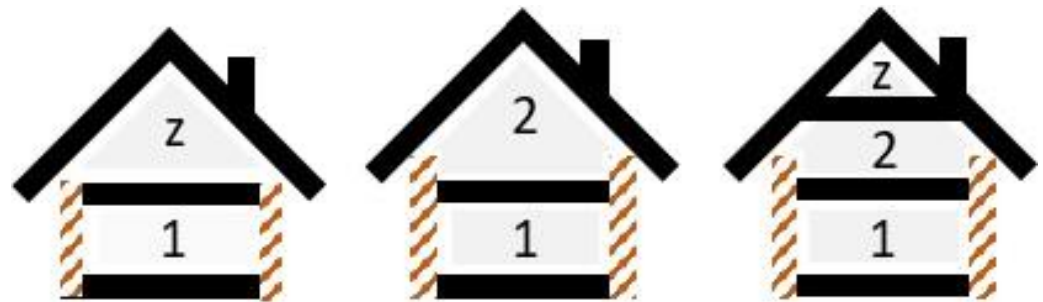
Figuur 11: Voorbeelden van doorsneden met 1 bouwlaag met opgaand metselwerk.
