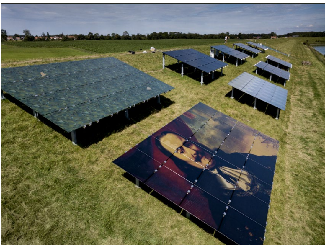
Figuur 3.9: Testopstelling voor Zon op Dijken in Ritthem
