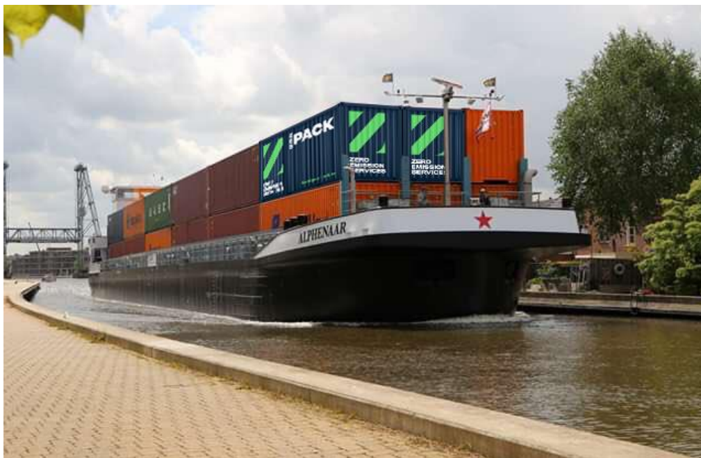
Figuur 20 Batterij-elektrisch schip Alphenaar (Nieuwsblad Transport, 2020)
