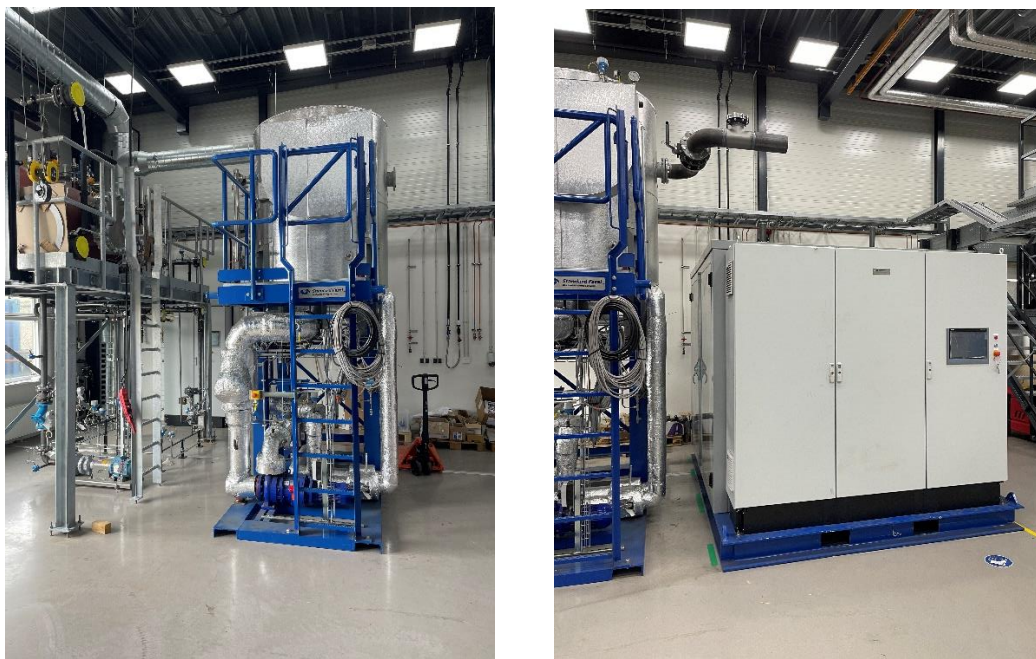
Figuur 3.14 Foto van experimentele stoomcompressor unit
