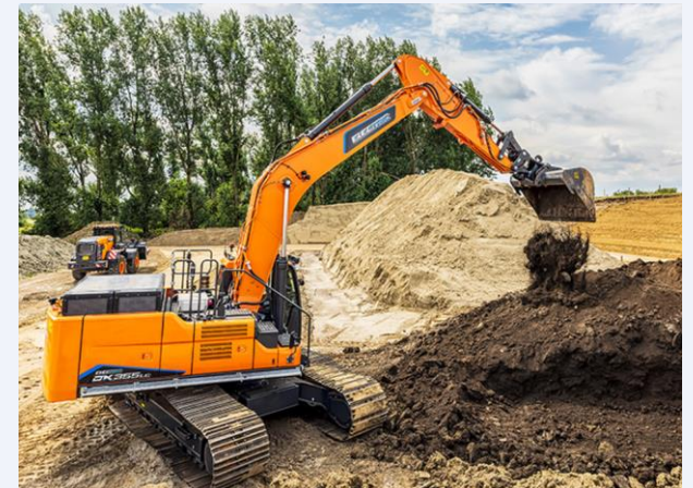
Figuur 2: 35-ton rupsgraafmachine (DX355LC).
