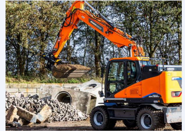
Figuur 1: 17-ton mobiele graafmachine (DX165W).
