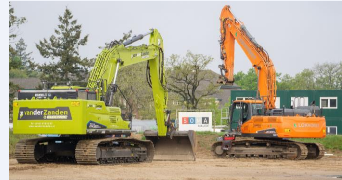
Figuur 15: elektrische rupsgraafmachine (links), diesel variant (rechts)
