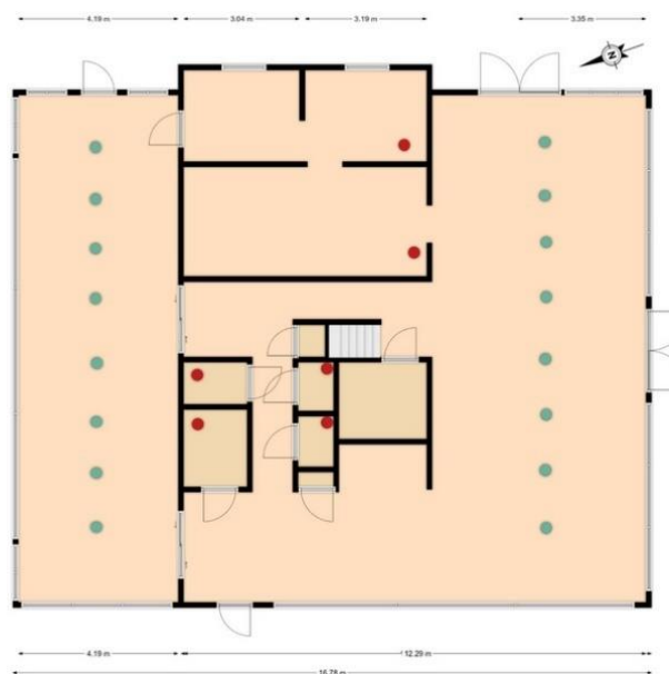
Figuur 8.1 Indicatieve plattegrond. Rood is afvoer, groen is toevoer.
