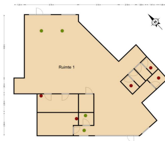
Figuur 4.1: Indicatieve plattegrond. Rood is afvoer, groen is toevoer.
