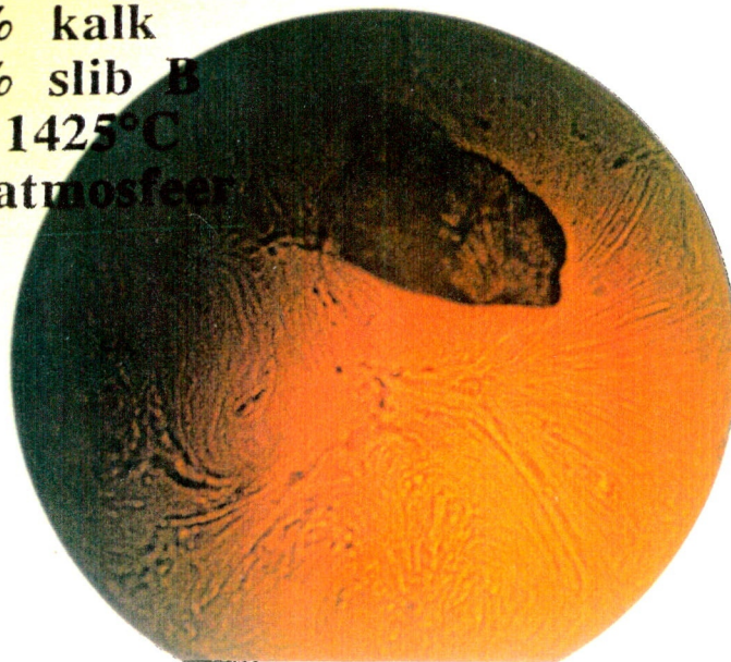
Glassmelt 3 21,14% kalk 78,86% slib B 2 uur 1425°C 2% O 2 atmosfeer
