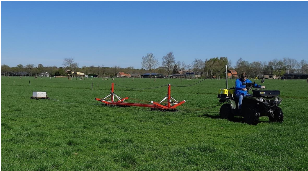
Figuur 1B. tTEM metingen uitgevoerd door een quad welke een zend- en ontvangstantenne voortsleept.
