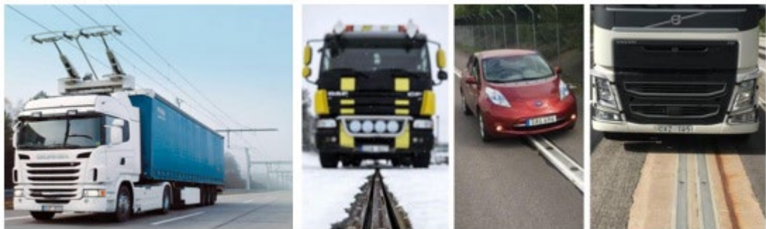
Figuur 2.1: Opties voor ERS (conductive), van rechts naar rechts: Bovenleidingsysteem, Onderbouwsysteem met rails in het wegdek, boven op de weg en gelijk met de weg
