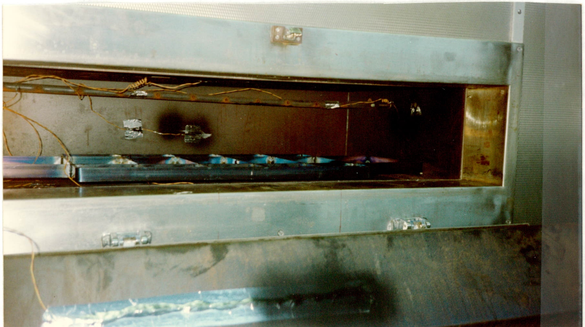
6 Het metalen frame is het weegplateau, waarop de produkten geplaatst werden. De buis bovenin is de stoomtoevoerbuis.
