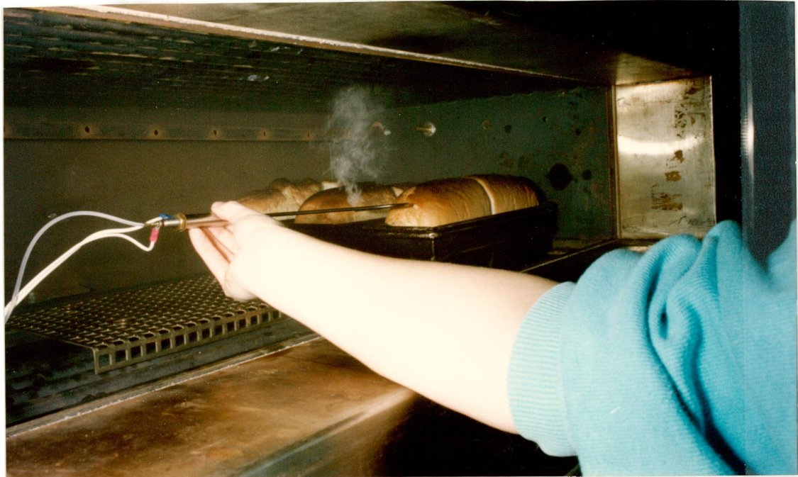
1 Met behulp van een rookgenerator kan een globaal beeld van de stroming verkregen worden.
