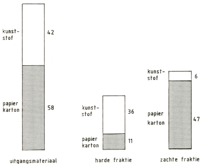
Figuur 11 Scheidingsresultaten mengsel van kunststoffen en papier/karton (systeem 2) met horizontale toevoerband
