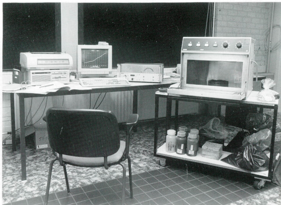
Figuur 4 De microgolfoven en het temperatuurmeetsysteem (KEMA)
