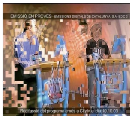
Figuur 8: Voorbeeld van IN: verstoring van een DVB-T-siginaal door een passerende trein (l) en het effect op de beeldkwaliteit (r), ontvangen in een nabijgelegen huis [bron: Leferink et al]
