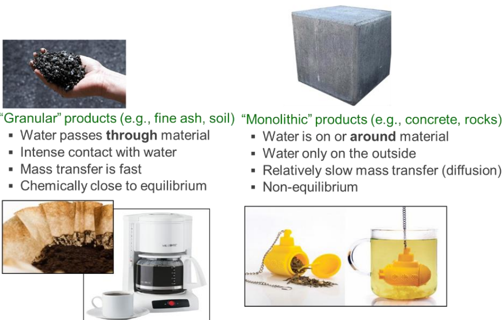
Figuur 1: Het onderscheid tussen diffusie- en percolatie- gecontroleerde uitloging (respectievelijk dominant bij vormgegeven en niet-vormgegeven materialen) is te vergelijken met het zetten van koffie of thee (Figuur JD).
