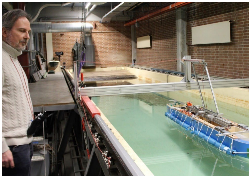
Figuur 5.5: Schaalmodel met verwijderbare luchtkussens voor het passeren van ondieptes. Foto (c) Hans Heynen
