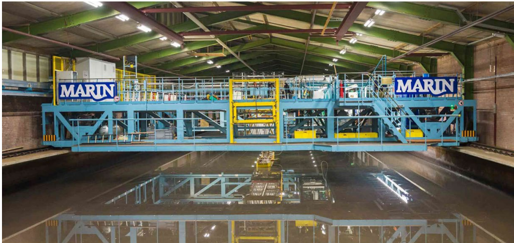
Figuur 5.6: Het 'shallow water basin' gebruikt voor testen met schaalmodellen van schepen. Foto: MARIN
