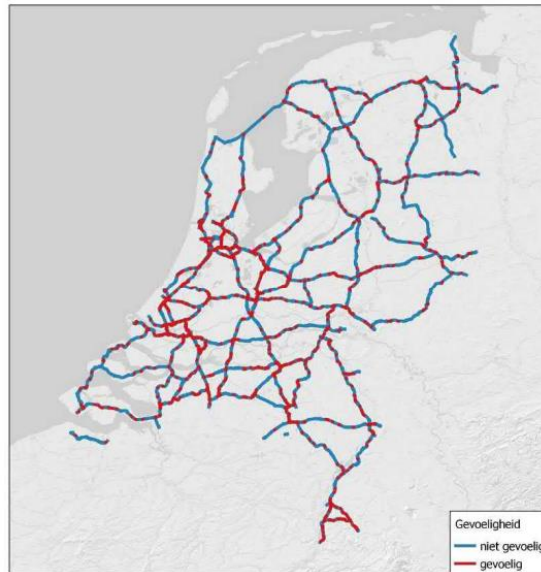
Figuur 5-9: Gevoeligheid hoofdwegennet voor erosie en afschuiving van het wegtalud door afstromend regenwater (Deltares, 2020)
