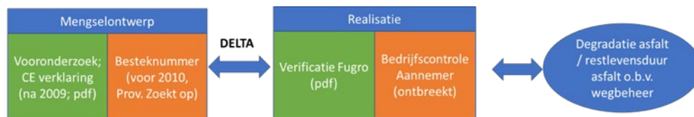
Figuur 4.1 Verschillen mengselontwerp-realisatie als basis voor datagedreven levensduurmodel
