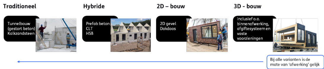
Figuur 2.4: Voorbeelden van de vier verschillende varianten van bouwmethoden. CLT = Cross Laminated Timber, HSB = Houtskeletbouw.
