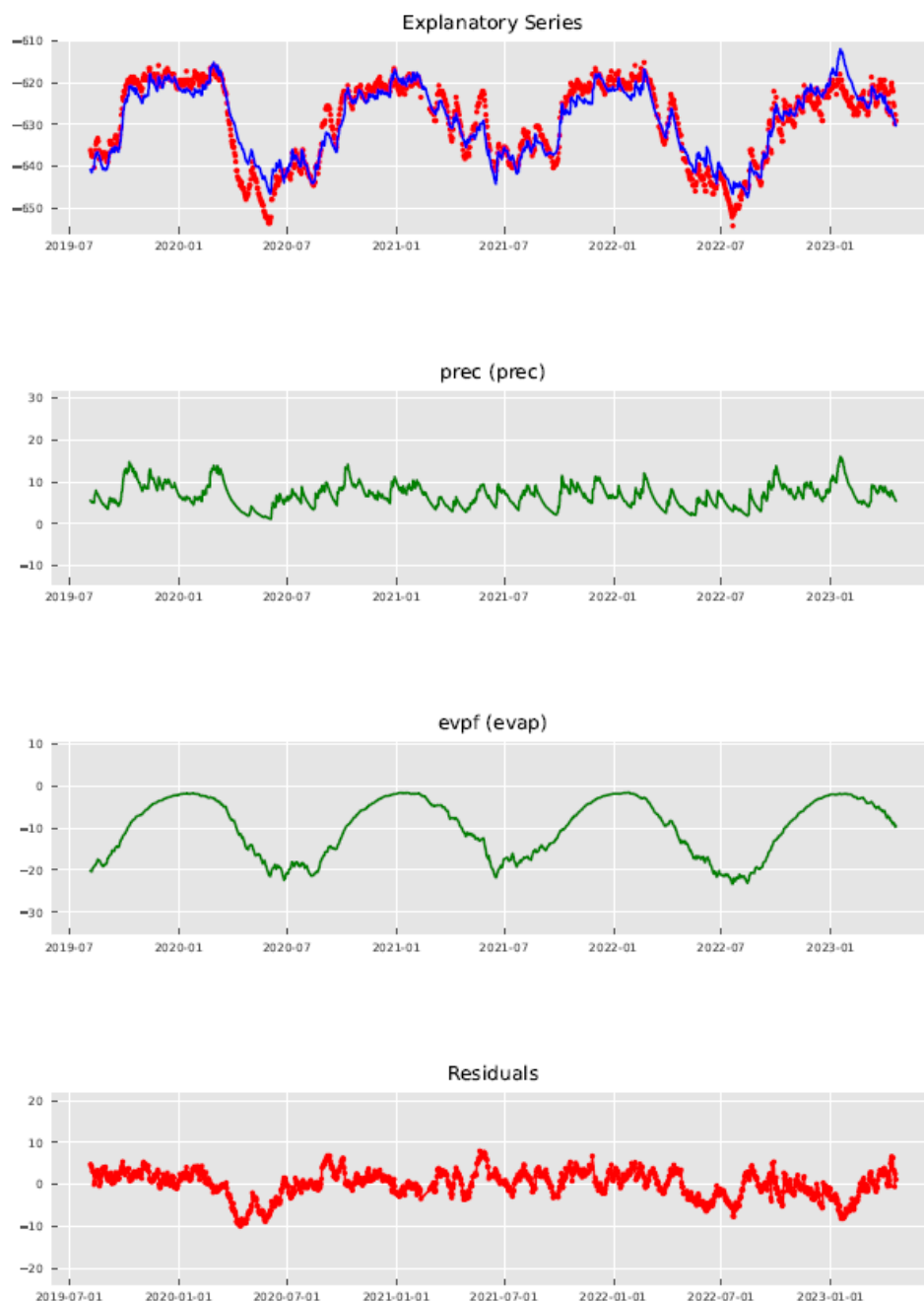
Figuur 10 Tijdreeksmodel voor de grondwaterstijghoogte in meetpunt DRV048 met neerslag (prec) en verdamping (evap) als verklarende factoren; de onderste grafiek geeft de verschillen tussen de gemeten en de berekende waarden (residuals).
