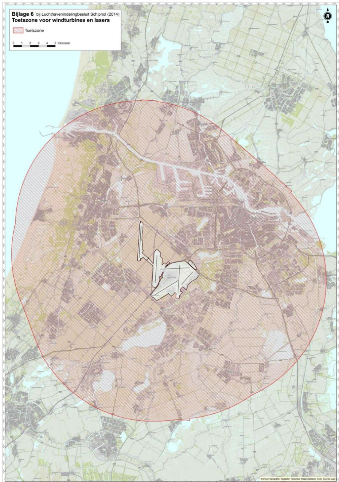
Figuur 17: Bijlage 6 van de LIB Schiphol, met de zone waarbinnen een bouwbeperking geldt voor windturbines met een ashoogte van hoger dan 35 m of voor (urban)windturbines bovenop een gebouw waarbij de tip meer dan 5 m uitsteekt, of waarbij de tiphoogte inclusief het gebouw hoger is dan 35 m (Bron: LIB 2016).
