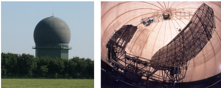
Figuur 56: De MPR gevechtsleidingsradar bij Wier. Rechts de radarantenne in de radome (Bron: Ministerie van Defensie).
