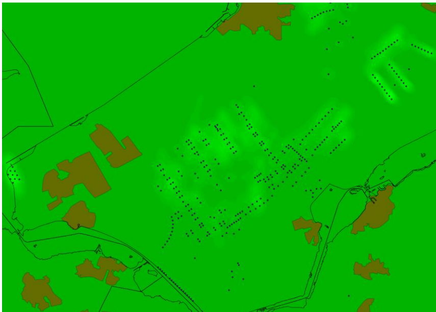
Figuur 27: Een voorbeeld van de radardetectiekans boven de Flevopolder. Aan de lichtere kleuren groen is te zien dat de windturbines een verlaging van de detectiekans ter hoogte van een park veroorzaken. De detectiekans blijft in dit voorbeeld echter binnen de norm van minimaal 90%.
