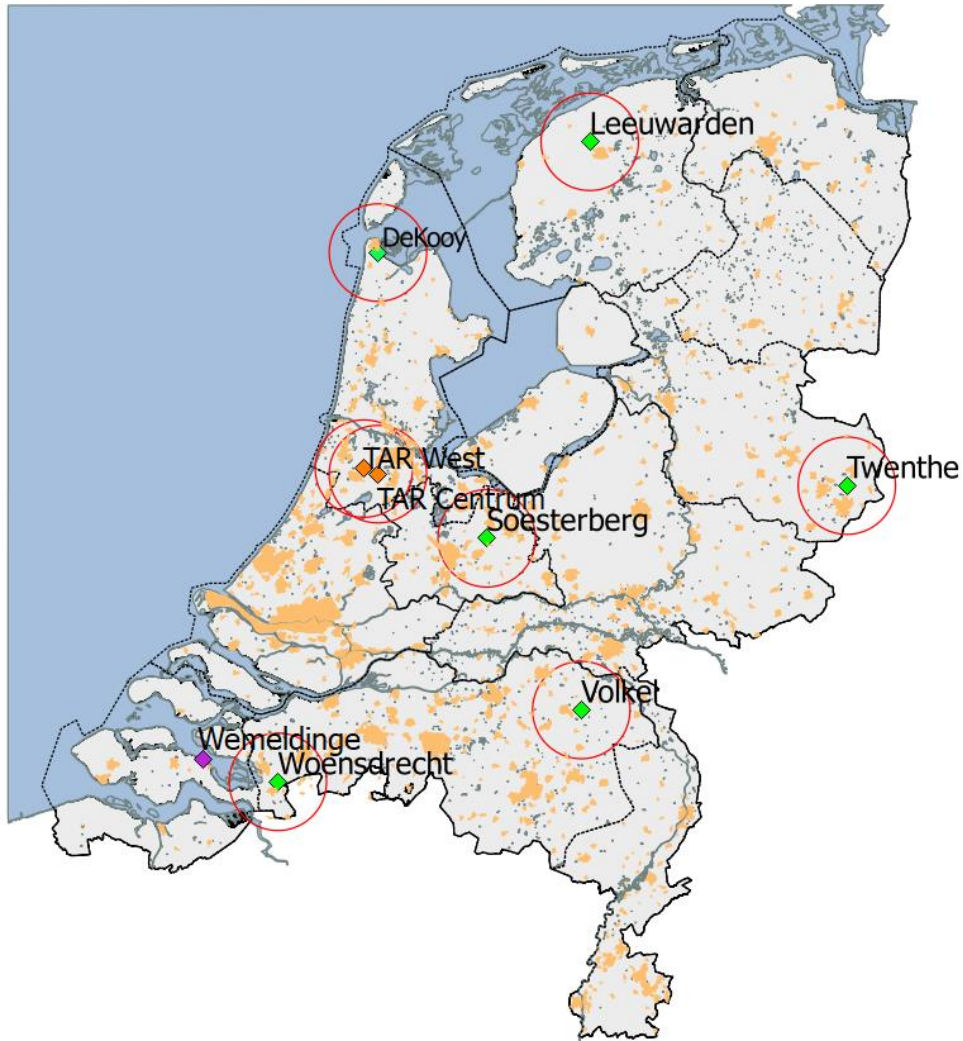
Figuur 14: De locaties van de zes MASS verkeersleidingsradars (groene ruit), de TAR West en TAR Centrum bij Schiphol (oranje ruit) met daaromheen de 15 km cirkels. De Scanter 4002 infill radar bij Wemeldinge (paarse ruit) beschikt niet over secundaire radar en heeft daarom ook geen eigen 15 km cirkel.
