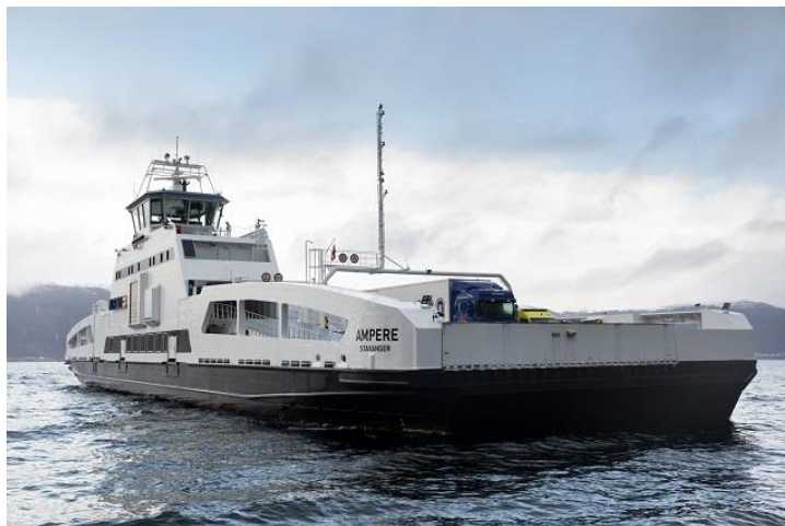
Figuur 5: Volledig elektrisch autoveer tussen Lavik en Oppedal (N). Vaarafstand 5,6 km en energie ca. 150 kWh per enkele reis.
