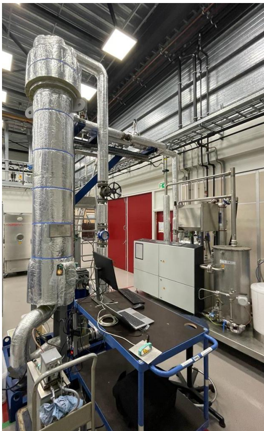
Figuur 4: foto van de Flexsteam unit met rechts de stoomgenerator en links het reactorvat met daarin de met PCM gevulde buizen.
