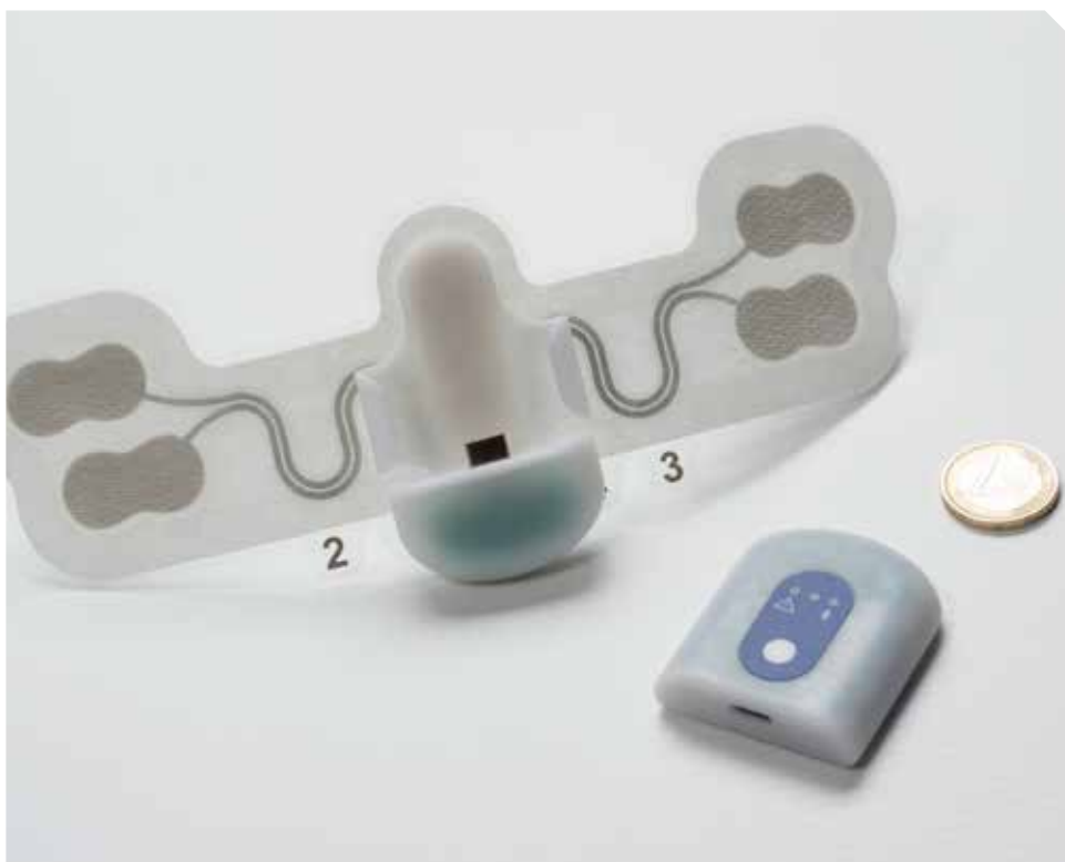
De Health Patch is een 'research-grade' meetpleister voor hoog-resolutie vital sign monitoring gedurende 5 dagen met toegang tot ruwe data. De Health Patch is ontwikkeld door TNO Holst Centre.
